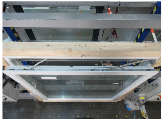
Bild 4 Scherenlager, Falzansicht Flügelrahmen
