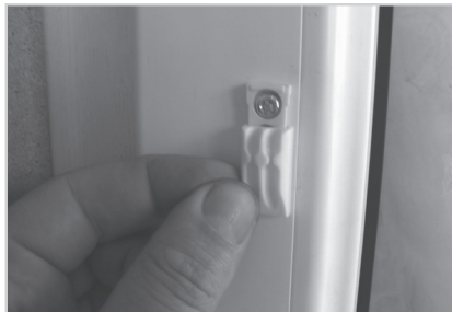
16. Kettenhalter Den Kettenhalter von der Kette nehmen und von unten auf die Basisplatte schieben.
