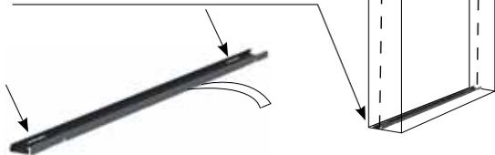
**B** Das Wandprofil (3) in die obere und untere Führungsschienen einsetzen und seitlich fixieren.
