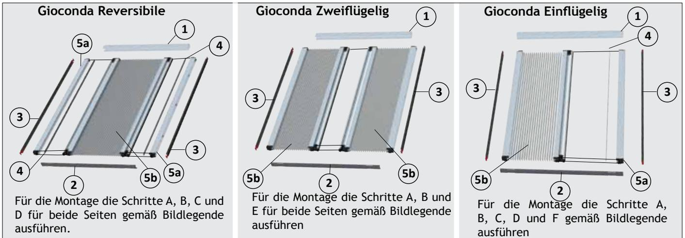
**A** Obere Führungsschiene (1) fixieren, und Untere Führungsschiene (2) vom Klebeband-Schutz Befreiung. Parallel auf den Boden legen.
