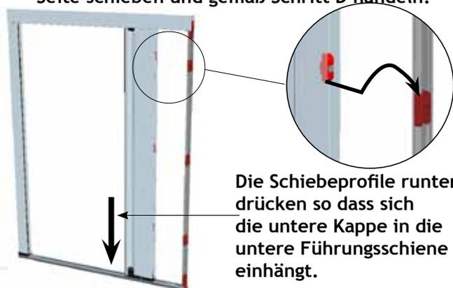
**F** der Verschiebung des lsg. Paket, im innern des Anschlagprofil befinden sich die zwei Schnüre der Spannungsregulierungen, welche nach Einhängen von Anschlagprofil mit dem Wandprofil fest eingeschraubt werden müssen.
