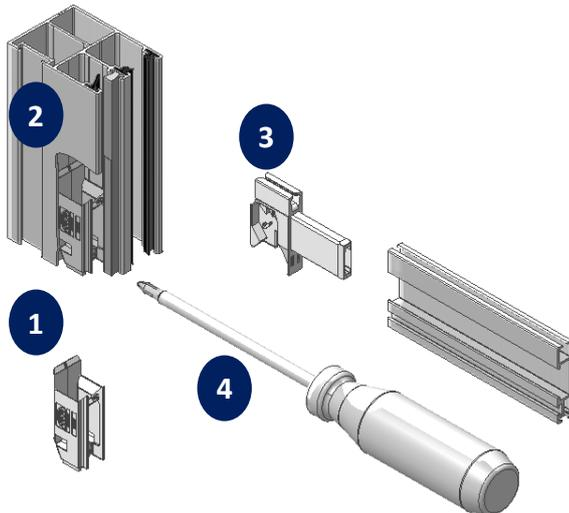
1. Endstücke in die Führungsschienen einschieben und Schrauben anziehen
